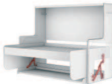
Parallelverschiebung der Arbeitsplatte nach unten bzw. oben
